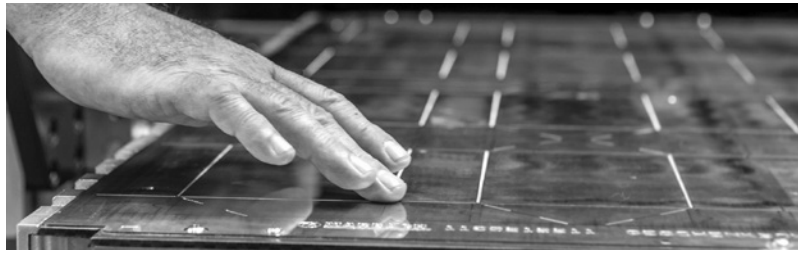
写真3●独Marbachのmillingによるcounter plate Atlas社では一部、腐食(etched)の方法も採用している。
